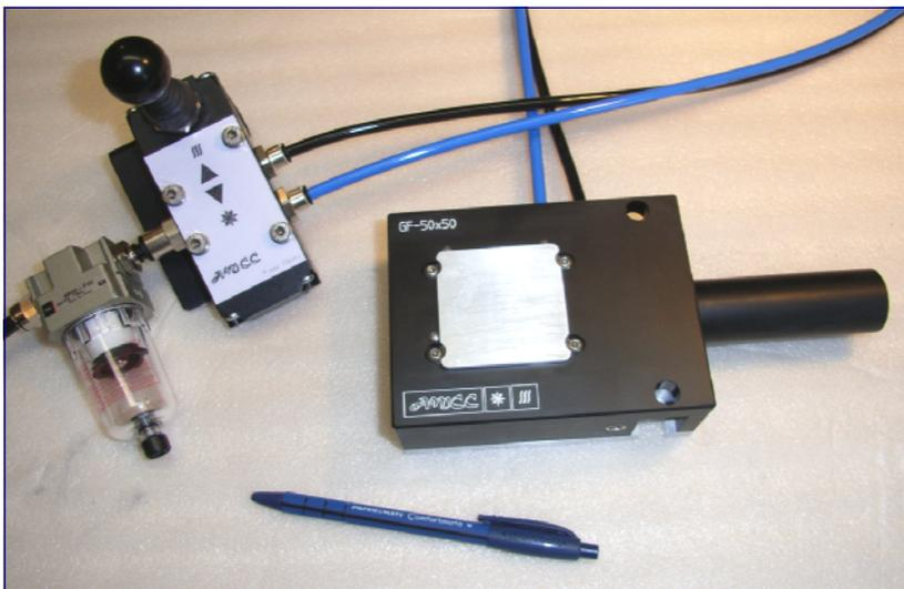
Raccordez l'appareil au réseau d'air comprimé<sup>3</sup>, pulvérisez de l'eau sur la plaque de congélation et déposez la pièce à usiner. Actionnez ensuite le levier du distributeur en position gel . En quelques secondes l'eau gèle et la pièce est bridée. Le débridage, tout aussi rapide, s'effectue en basculant le levier sur dégel .
