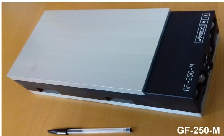
Raccordez l'appareil au réseau d'air comprimé<sup>3</sup>, pulvérisez de l'eau sur la plaque de congélation et déposez la pièce à usiner. Actionnez ensuite le levier du distributeur en position gel ❄️. En quelques secondes l'eau gèle et la pièce est bridée. Le débridage, tout aussi rapide, s'effectue en basculant le levier sur dégel 🌊.
